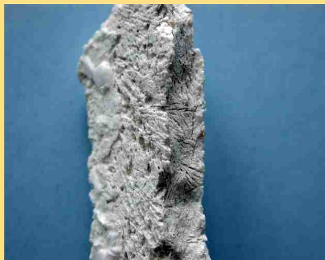
Frostschaden in der Armierung und im Deckputz (sichtbare Eisblumen)
